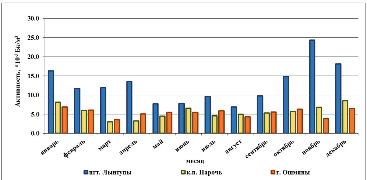
Рисунок 10.8 – Среднемесячные значения суммарной бета-активности в пробах аэрозолей на пунктах наблюдений в районе размещения Белорусской АЭС за 2021 г.
