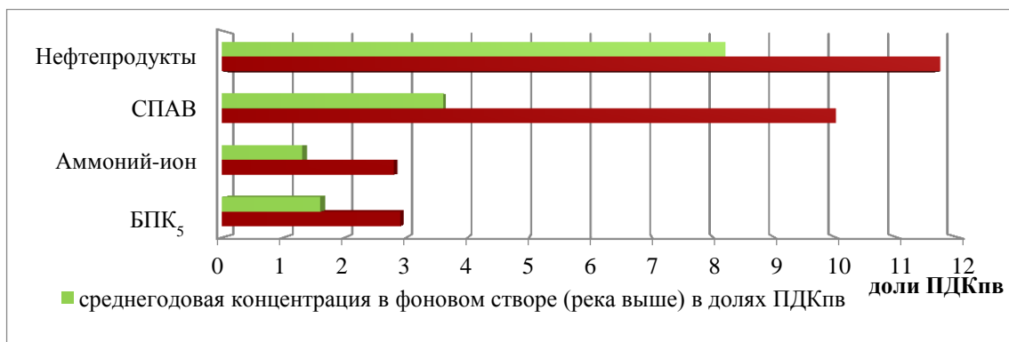
Рисунок 11.12 – Среднегодовые концентрации загрязняющих веществ в фоновом и контрольном створах р. Вязынская в долях ПДК пв
