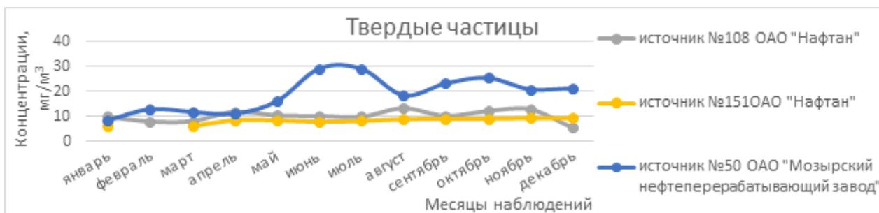
Рисунок 11.25 – Концентрации твердых частиц в выбросах от источников нефтеперерабатывающего производства в 2020 г.
