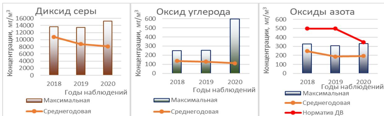
Рисунок 11.24 – Концентрации загрязняющих веществ в выбросах от печей производства серы (источник № 1470) ОАО «Мозырский нефтеперерабатывающей завод»
