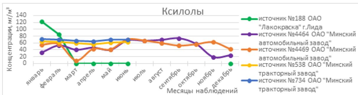
Рисунок 11.17 – Концентрации ксилолов в выбросах от окрасочных камер в 2020 г.
