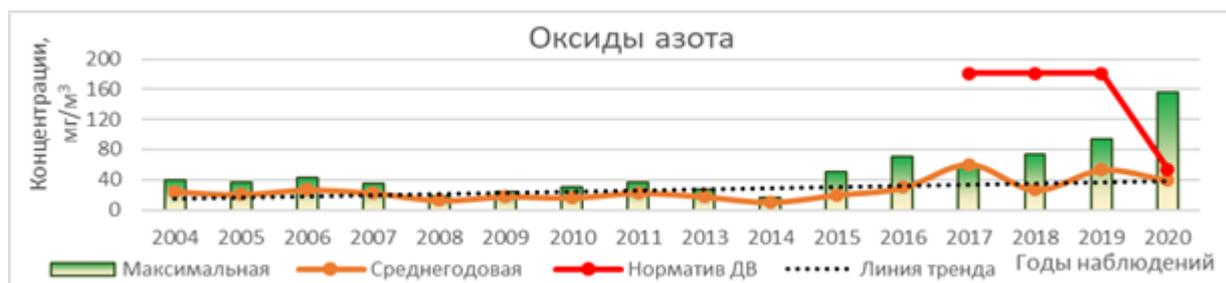
Рисунок 11.15 – Концентрации оксидов азота в выбросах от сталеплавильной печи (источник № 2) ОАО «Белорусский металлургический завод»
