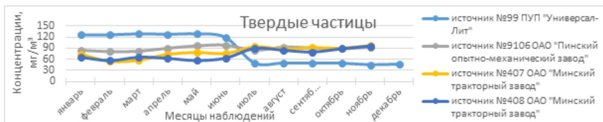
Рисунок 11.14 – Концентрации твердых частиц в выбросах от сталеплавильных печей в 2020 г.
