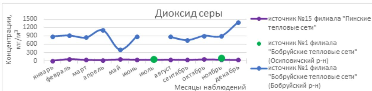
Рисунок 11.5 – Концентрации диоксида серы в выбросах от котлов, работающих на биомассе, в 2020 г.
