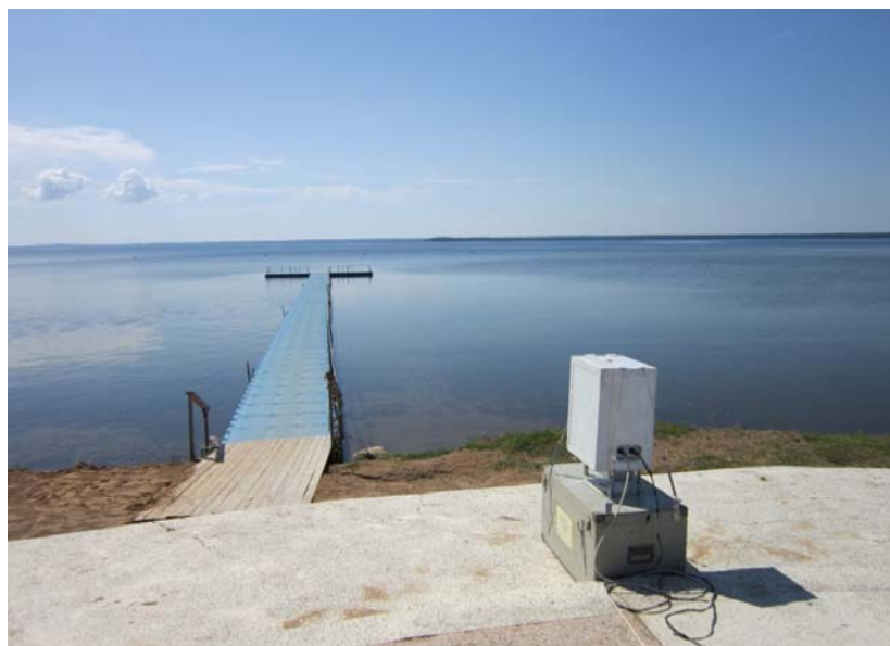
Рисунок 5.2 – Проведение измерений спектрального состава естественного приземного излучения на озере Нарочь с помощью спектро радиометра ПИОН-УФ-П
