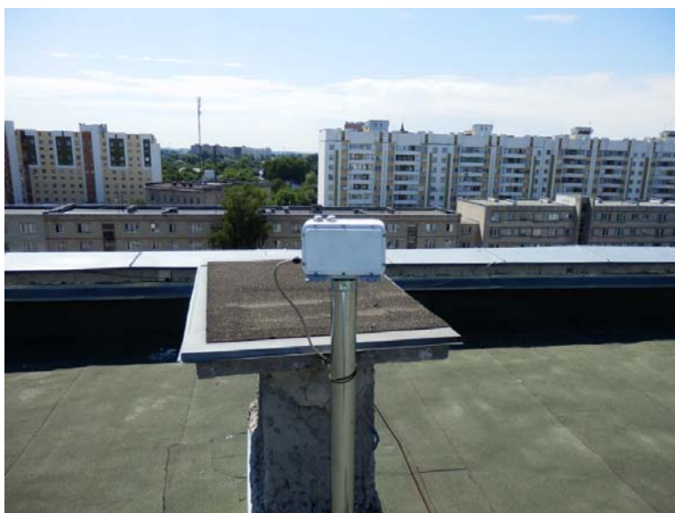
Рисунок 5.1 – Сетевой двухканальный фильтровый УФ фотометр ПИОН-Ф на измерительной площадке Гомельского университета
