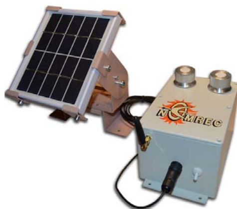
Рисунок 5.3 – Внешний вид блока фильтрового фотометра ПИОН-ФН с панелью солнечной батареи
